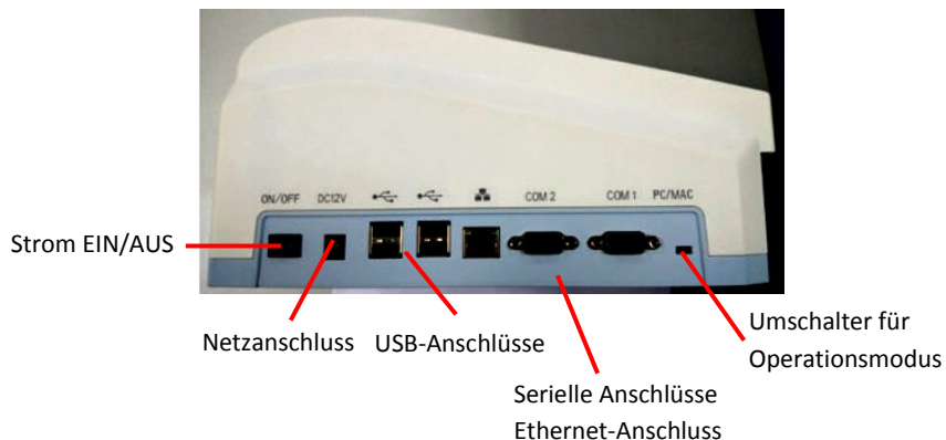
Abb. 2.2: Fineware™ FIA Plus Anschlüsse – Ansicht von links
