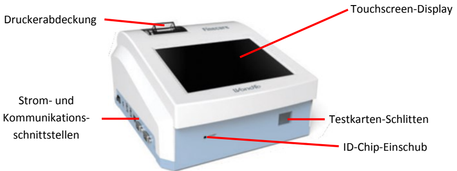
Abb. 2.1: Finecare™ FIA Plus – Frontansicht
